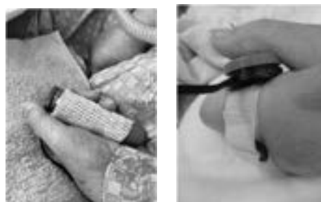
(プラスチックボトル) (マジックテープ) スペックスイッチの工夫
