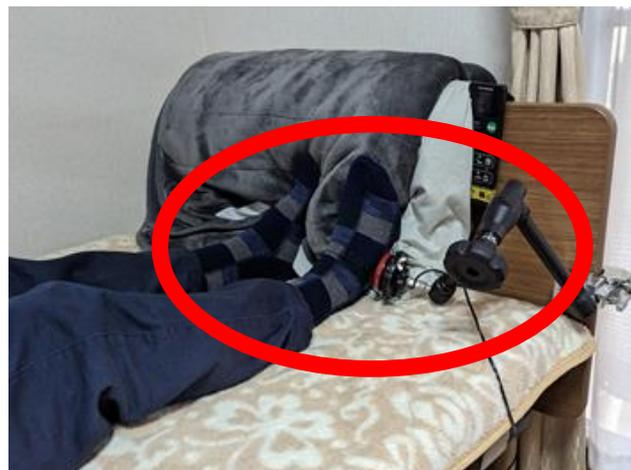
図6 ベッドに取り付けられた固定具を設置、ジェリービーンスイッチのみでカーソル操作・決定を行っている様子
