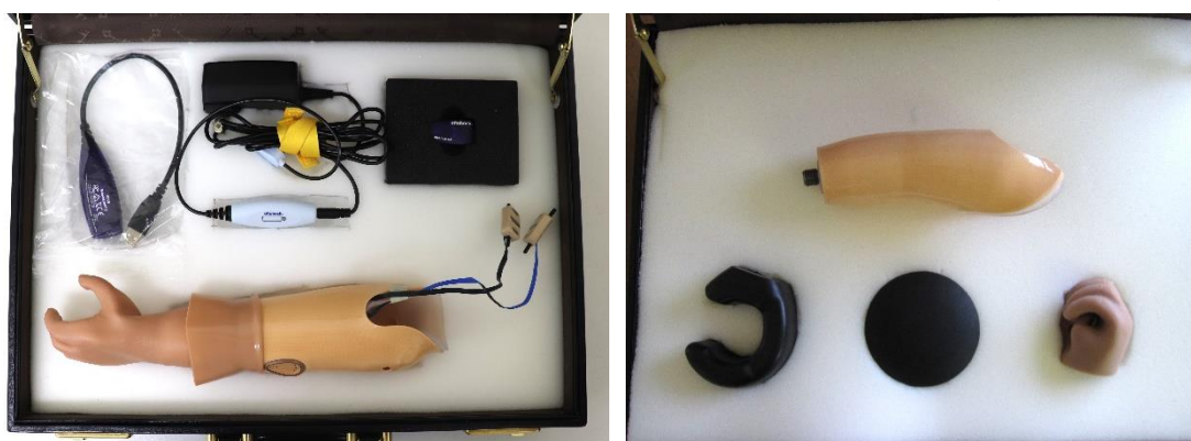
前腕義手殻構造電動式一式（左）と作業用義手一式（右）
