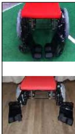
写真7 フットサポート電動開閉
