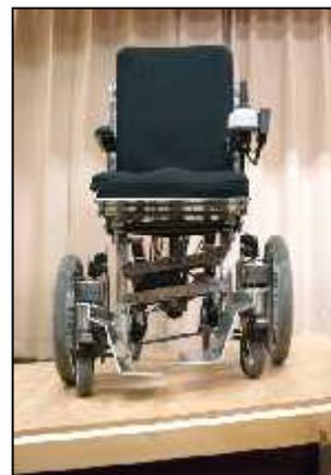
写真10 傾斜修正機構
