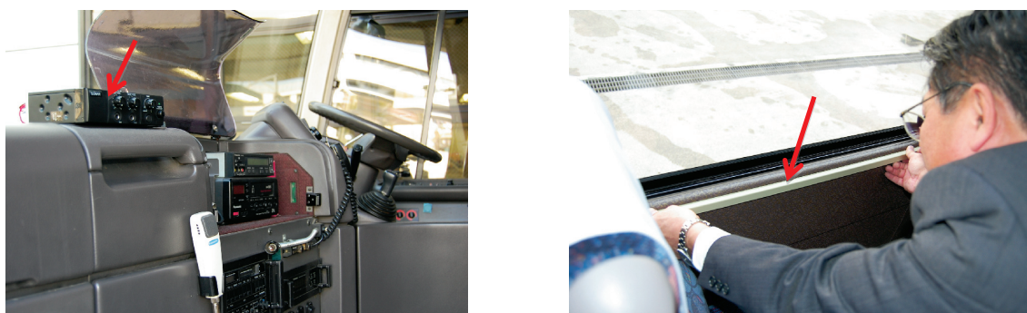
図1 (磁気ループアンプの設置写真、ループアンテナの設置写真)
