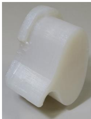
図2 カップホルダー製作用持ち手曲げ治具
