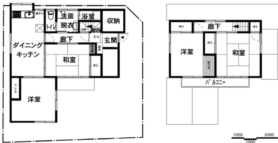
図 3-1. 事例①の改修前の図面
