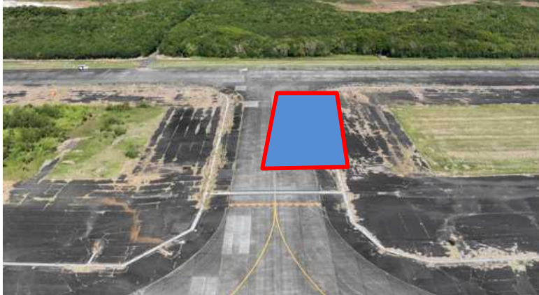
硫黄島滑走路 実施サイズ(長さ:約50m(予定)×幅:約23m×深さ:約3m※S19旧地表面まで)
