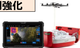
夜間監視・熱源探査ドローン
