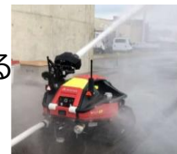
遠隔操作消火ロボット
