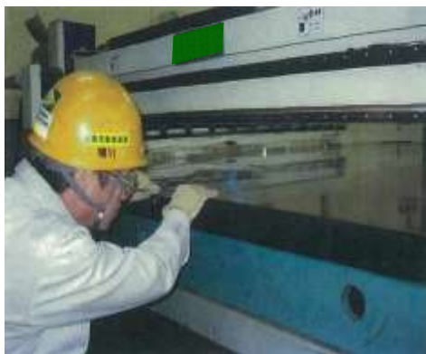
目視での歪み確認作業
