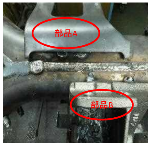
[大型トラックの車軸部品仮付け溶接(左) 本付け溶接(右)]
