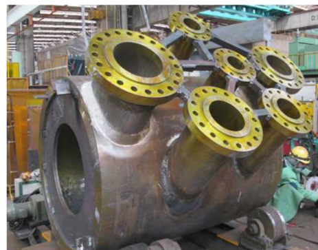
〔圧縮機ケーシング〕
