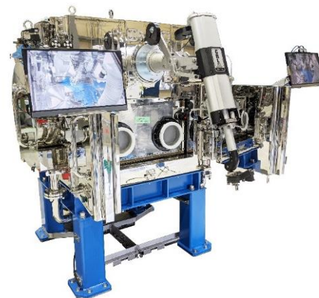
[廃炉向け鉛遮へい付グローブボックス]
