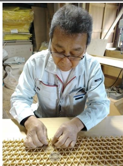
[組子障子に取り付ける組子製作作業]
