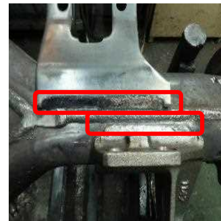
[大型トラックの車軸部品仮付け溶接(左) 本付け溶接(右)]
