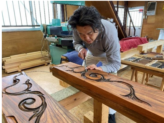
【虹梁若葉模様の彫刻の仕上げ彫り作業】
