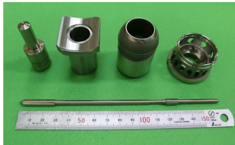
[自動車の研究試験部品-長尺極細/特殊形状/球面]
