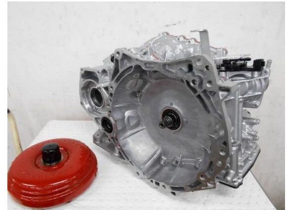
【CVTトランスミッションの再生完成品】
