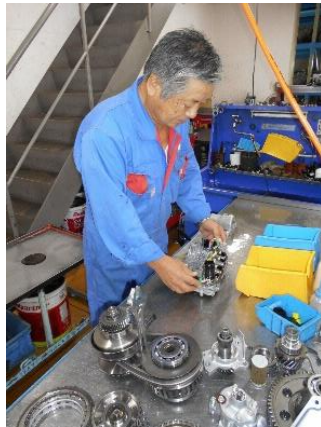
【CVTトランスミッション分解修理の様子】
