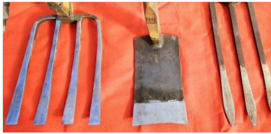
〔「鍛接・鍛造・水焼き入れ」などの日本古来の手法により製造された佐倉鍛造刃物〕
