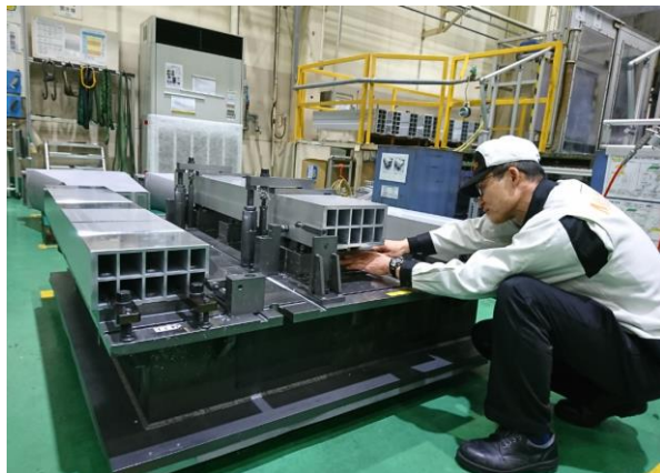
【材料をより自然な状態で固定し加工できる自在治具】
