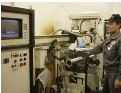
[バラシングマシンによる主軸のバランス確認作業]
