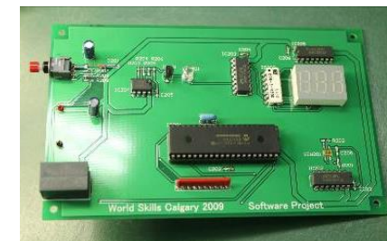
【左：試作基板（すずメッキ軟銅線による配線） / 右：競技用プリント基板】
