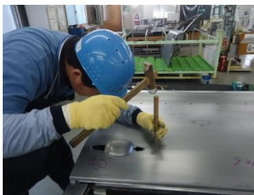
〔試作部品製作(面出し作業)〕
