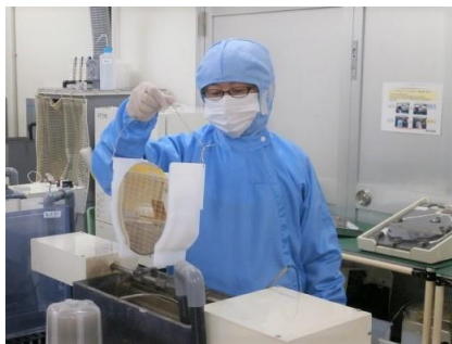
【接合強度対応無電解 Ni-Au めっきの仕上がり状態確認】
