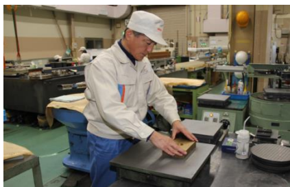
[高精度測長機部品のラップ仕上げ]
