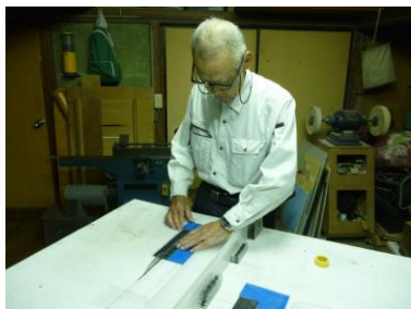
[アクリルの細かいカット作業]
