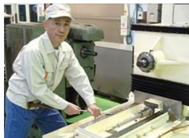
[精密機械摺動面のキサゲ作業]
