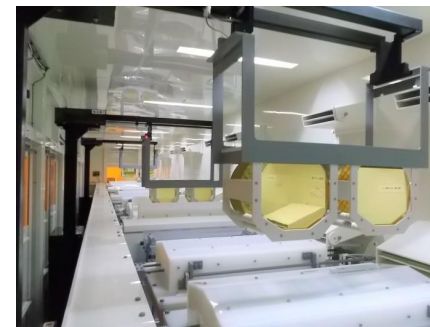
【パワーデバイス接合強度対応無電解 Ni-Au 自動ライン】
