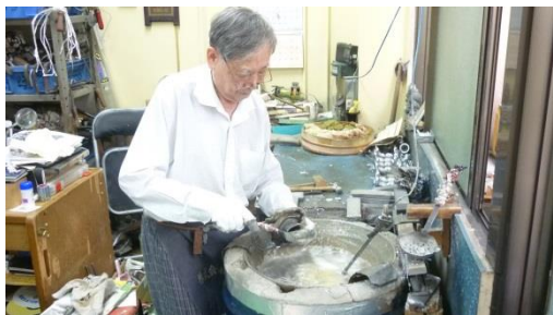
【「戻し吹き」のうち、鋳型への流し込み作業】
