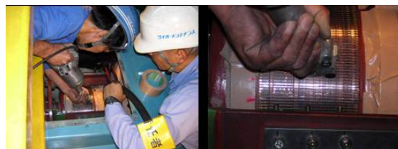
旋盤をカスタマイズして手で持てる大きさに改造して、小さな穴から旋盤の溝を削る。熟練だからこそできる技である。
