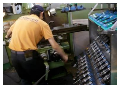
フライス盤の先端につける多様な工具 加工するものにあわせて使い分ける
