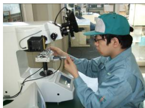
藤永技能士の硬さ試験の様子
