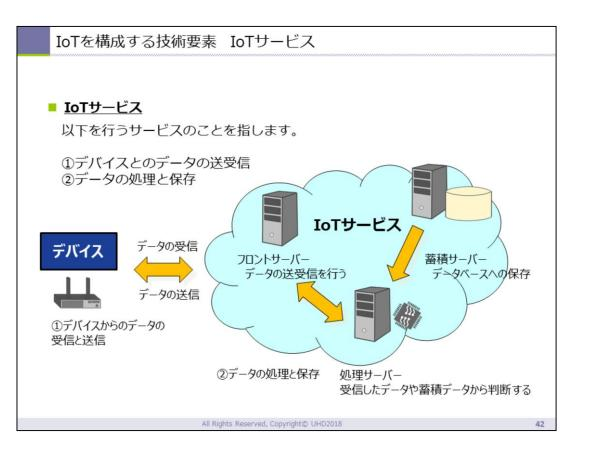
IoTサービスはデバイスから送られてきたデータを受信したり、蓄積、分析したり、サービスを行ううえで必要な処理を行うサーバーサイドの処理です。サーバーの主なものは下記です。
