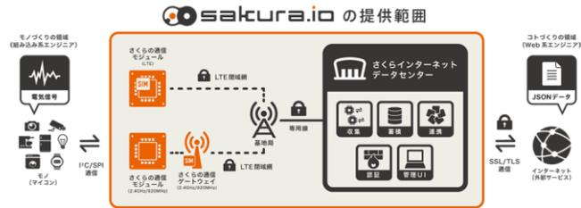
「電気信号」と「JSONデータ」の相互変換装置として動作し、これまでのIoTデバイス/サービス開発の中間層を補完することで、モノ/サービスづくり・連携に注力が可能です。
