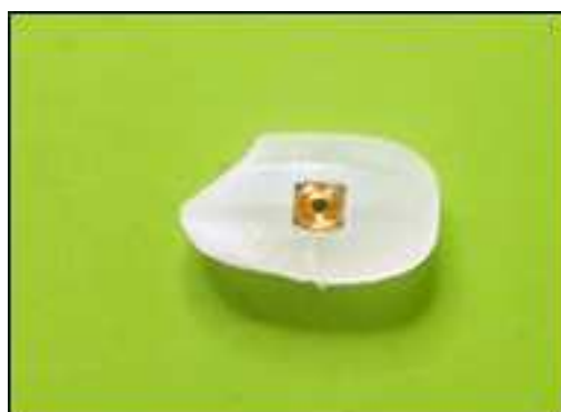
世界最小クラス1mmのICタグ
