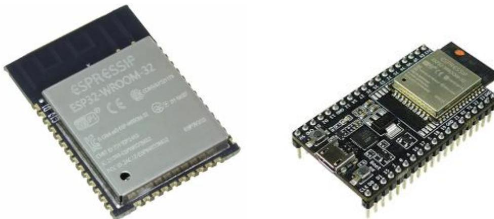
Arduino は通信機能を持たないため、Arduino に Wi-Fi 機能をプラスするために用いられるのが ESP32-WROOM32 です。ただし、ESP32-WROOM-32 は半田付けが必要で、Arduino とも多数の結線が必要になります。そのため、もっと簡単に使用できるようにピンヘッド等を接続したものが ESP32-DevKitC（技適取得済み）です。
