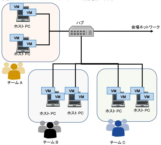
数人で1つのチームを組み、クライアント PC とサーバを操作します。サーバには Windows 10 上に仮想化アプリケーションを、クライアントには Windows 10 を使用します。サーバには仮想マシン(VM)を構築し、その VM をクライアント PC から接続して演習を行います。
