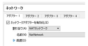
NAT ネットワーク配下の IP アドレスが割り振られていますが、DNS サーバ等は、上位のネットワークで設定されたものを継承しています。
