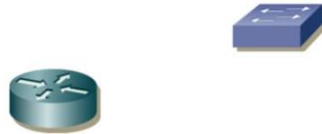
物理マシンをネットワークに接続する際に必要な仮想ネットワーク装置です。仮想マシンからは物理スイッチ、物理ルータとして見え、それぞれの役割も物理機器と同様です。インターネットプロトコルによって構成されているネットワークに接続する場合は、NAT（Network Address Translation：ネットワークアドレス変換）が必要なため、仮想ルータを利用します。また、VLAN（Virtual Local Area Network：仮想LAN）を構成する場合には仮想スイッチを利用してネットワークに接続します。
