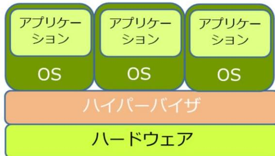
Type-Iのハイパーバイザの特徴は、ハードウェアに直接インストールし、仮想環境を稼働させるところにあります。ホストOSを介せずに直接仮想環境からハードウェアを制御することが可能なため、ハードウェアの能力を有効に利用することができます。狭義では、ハイパーバイザとはこのType-I型のハイパーバイザのことを指します。
