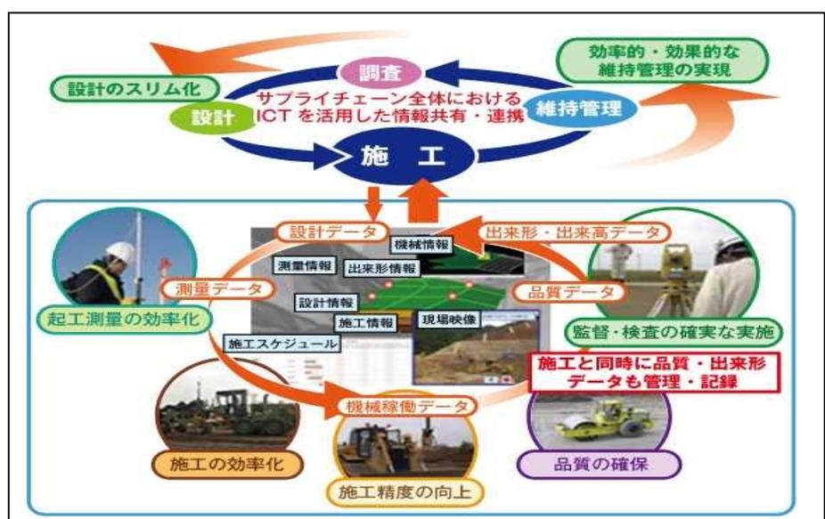
ら得られる電子情報を活用して高効率・高精度な施工を実現し、さらに、施工で得られる電子情報を他のプロセスに活用することによって、建設生産プロセス全体における生産性の向上や品質の確保を図ることを目的としたシステムです。
