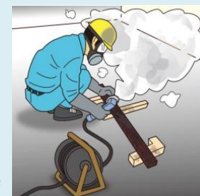
手持ち電動グラインダーによる廃棄木材の切断作業
