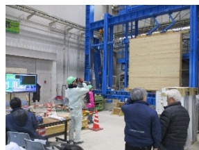
▲構造試験（面内せん断実験）
