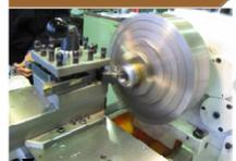
加工中の写真です。材料を回転させて削ります。「るくる」や「リンゴの皮むき器」と同じような機械です。
