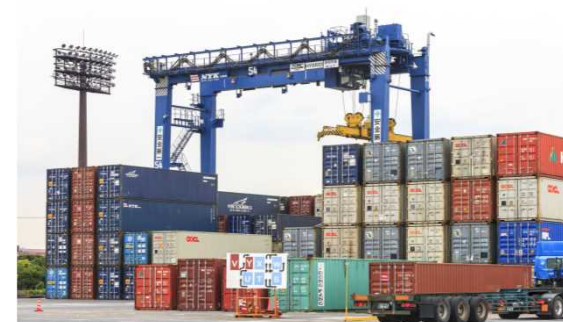
トランスファークレーンの外観
