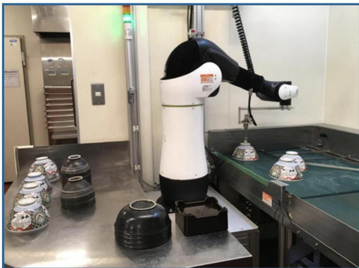
従業員が汚れた食器をコンベアに伏せて流すと、食器洗浄機が洗浄。洗浄機から出て濡れた状態の食器を、COROが内蔵カメラで読み取り、大きさや形など種類ごとに積み重ねて棚に収納する。食器をある程度積み重ねると、従業員に通知。安全のため、従業員がCOROに近付くとセンサーが検知して作業を一時停止する仕組みも備える。
