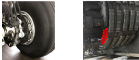
正常なブレーキ ブレーキ板が一部欠落
