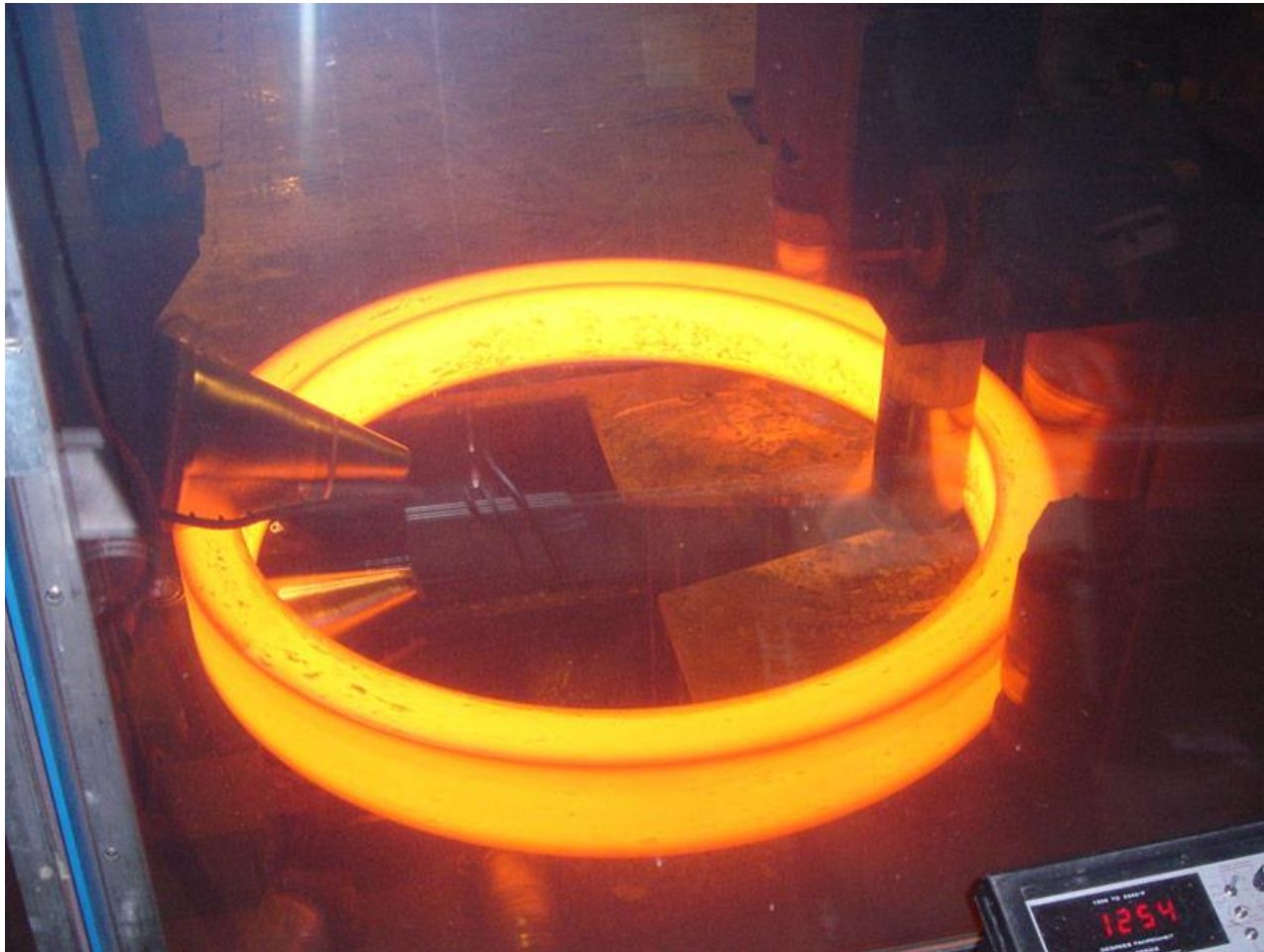
リング鍛造 圧力ケースの素材
