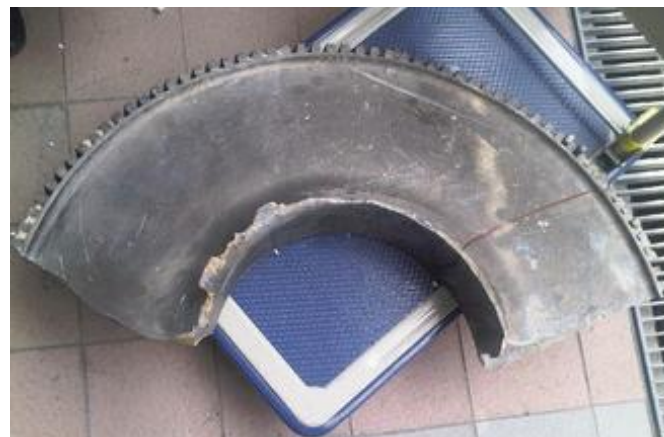
飛散した中圧タービンディスク
