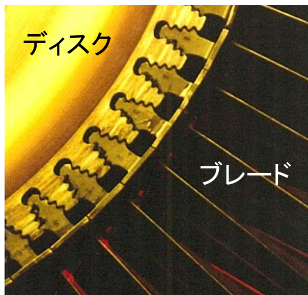
クリスマスツリー構造 (ディスクとブレードの固定)
