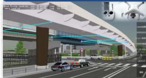
3DVRと連動する自律飛行型UAVによる構造物調査システム
