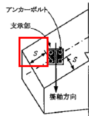
斜橋、曲線橋の支承縁端距離 S
