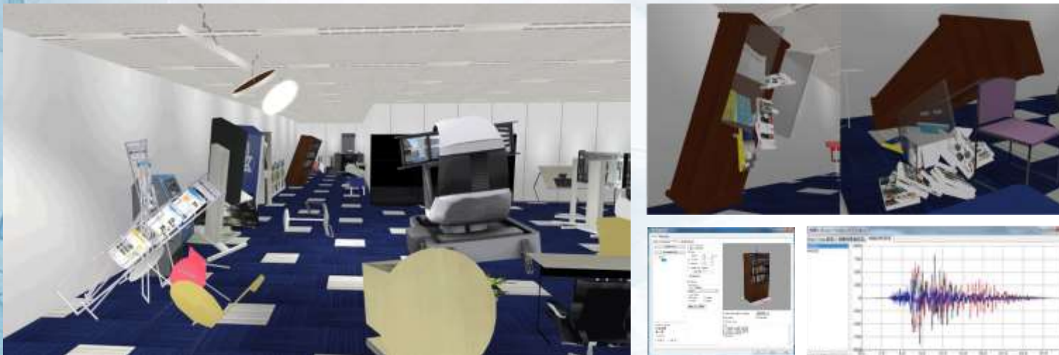
▲加振データを適用し構造物の物理モデルを考慮したVRによる高度な地震シミュレーションシステム
