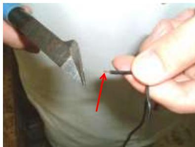
■ ニッパーの被膜剥き用の穴にコードをかませて被膜を5mm程度剥く
