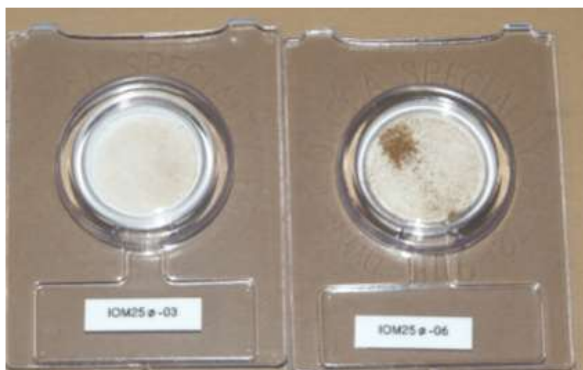
図 2 粉じん濃度 14.4\text{mg/m}^3 のフィルター (左) 148.16\text{mg/m}^3 のフィルター(右)
