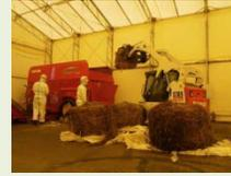
ロールを搬入し重量を測定後、ラップ等を取り除き、裁断機で裁断又はチップパーで粉砕
