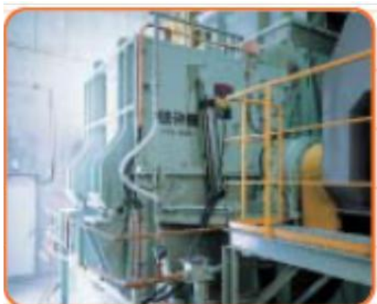
混合廃棄物処理ライン用破碎機 (コンクリートがら処理破碎機)
