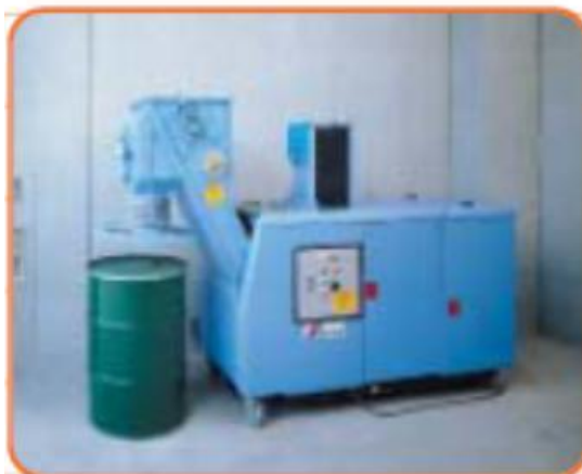
蛍光灯処理ライン用破碎機
