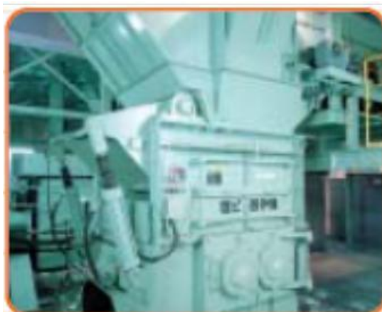
塩ビ系廃プラスチック類処理ライン用破碎機
