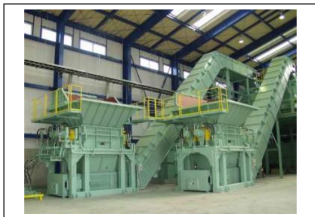
図 4-3 破砕機の屋内設置の例
