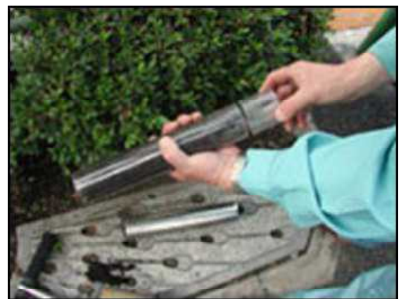
円筒ライナーにキャップを付け、試料名等を記載する。(6)
