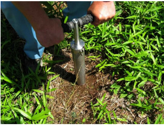
採土器を垂直におき、荷重をかけながらハンドルを回して押し込む。(2)
