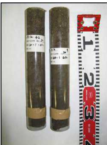
灰色低地土（粘土含量33%、LiC）水田での採取例（7）
