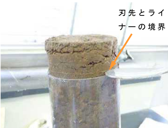
ライナーの外側に刃先まで土が残っている場合には、切り落とす。(5)
