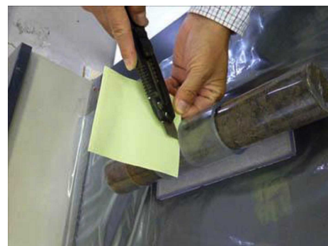
土壌がくずれやすい場合は薄いプ ラスチックの板を切り目に挿
