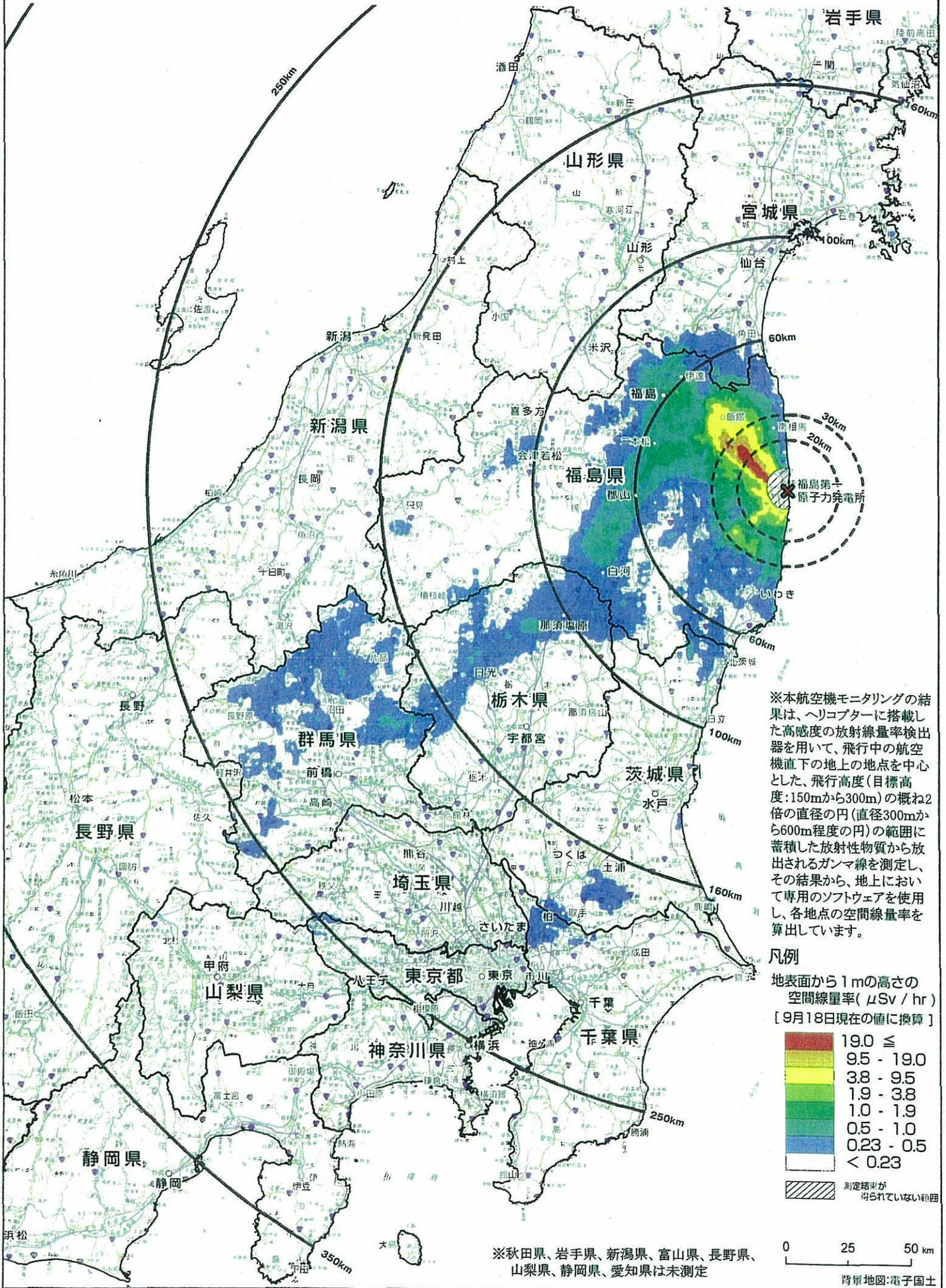
※本航空機モニタリングの結果は、ヘリコプターに搭載した高感度の放射線量率検出器を用いて、飛行中の航空機直下の地上の地点を中心とした、飛行高度(目標高度:150mから300m)の概ね2倍の直径の円(直径300mから600m程度の円)の範囲に蓄積した放射性物質から放出されるガンマ線を測定し、その結果から、地上において専用のソフトウェアを使用し、各地点の空間線量率を算出しています。
