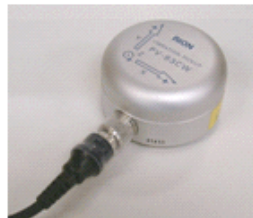
PV-83CW (ISO-2631-2 に 適合した 3 軸ピックアップ)
