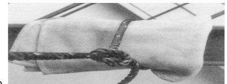
切断防止措置（養生）の例
