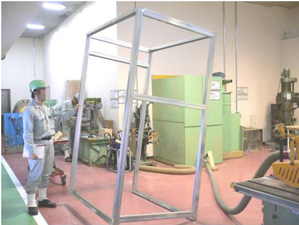
建築で使用する安価な部材を利用して箱を作成
