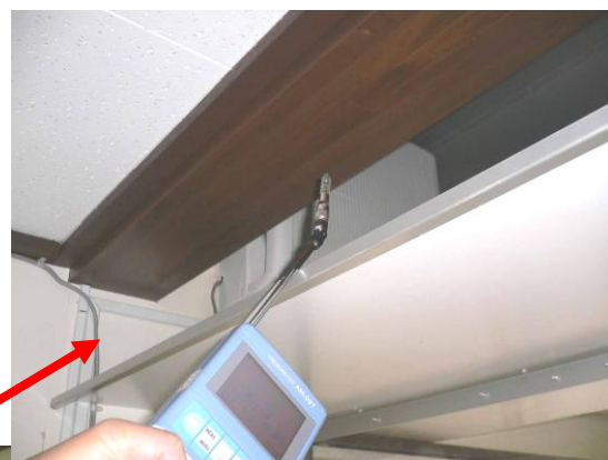
排気口における 風速測定
