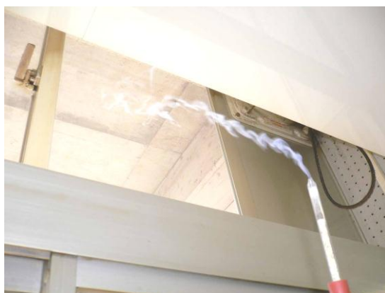
排気口：屋内側の窓を外し下3分の1を排気口とし、さらに、屋内下側の窓を開けることで二重窓の間の空間を通して排気が行われる
