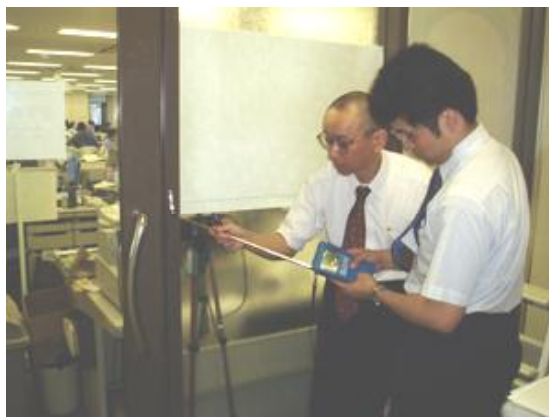
ドアストッパーでメイクアップ・エアを確保、その流速は2m/s
