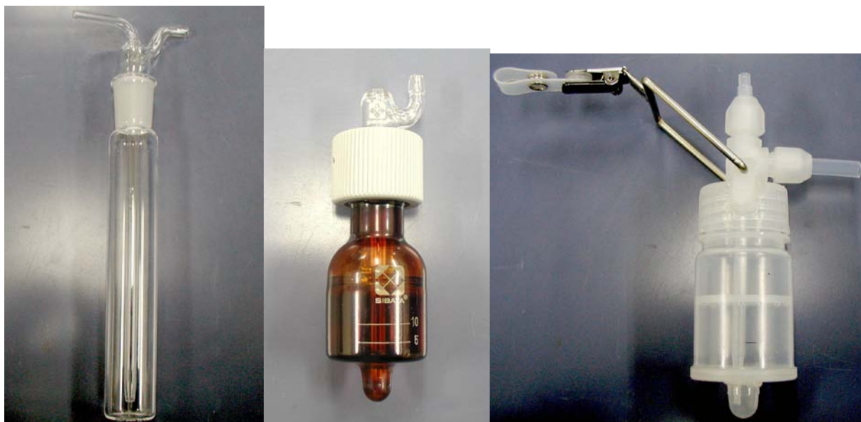
a) 石英製マイクロインピンジヤー b) ガラス製マイクロインピンジヤー c) ポリプロピレン製マイクロインピンジヤー 写真1 インピンジヤー
