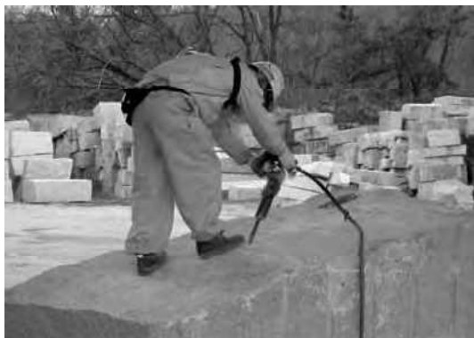
作業者 D-3, 6, 8, 9 （削孔：小割）
