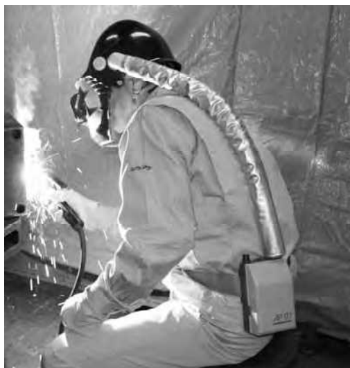
図 56 フェイスシールドタイプの PAPR の例。 溶接面の取り付けや併用が可能な場合が多く、吸気口が着用者の背後にあるため、溶接作業に適している。
