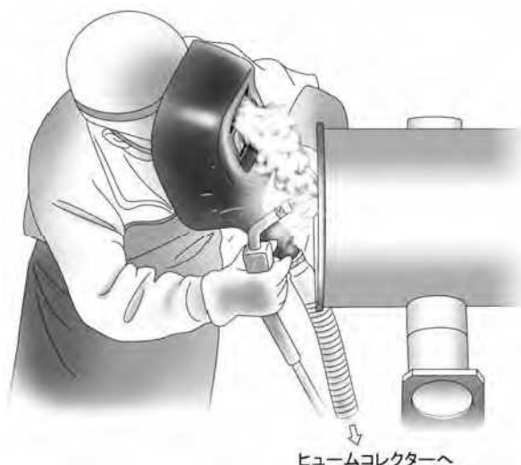
図 53 吸引溶接面を使用した事例
