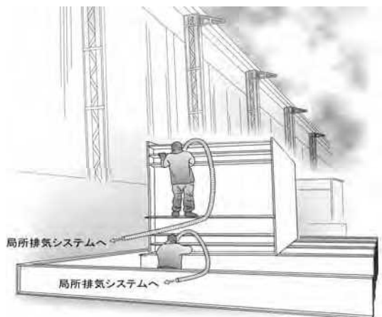
図 50-1 屋外アーク溶接作業への応用例 1
