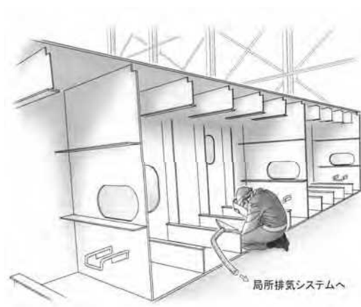
図 50-2 屋外アーク溶接作業への応用例 2
