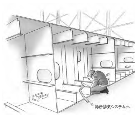
図 50-2 屋外アーク溶接作業への応用例 2
