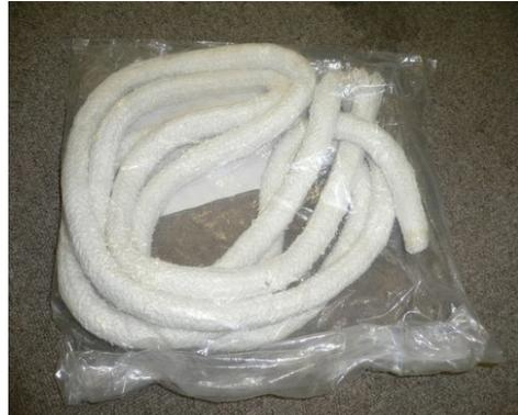
図 2-6 アスベストリボン (左) 及び アスベスト紐 (右)
