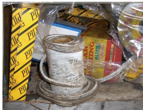
図 2-10 低圧配管用フランジシートパッキン (左) 及び 弁グラウンドパッキン (右)
