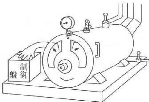
信頼性が証明された制御装置(自動停止機能等)を装備したボイラーの点検頻度の延長(3日に1回以上)による自動運転期間の延長(3日間)
