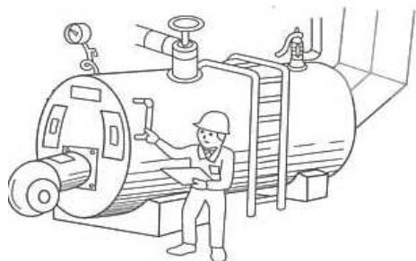
信頼性の確認できない制御装置(自動停止機能等)を装備したボイラーの資格者による点検(1日に1回以上)
