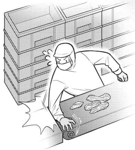
不仅是搅拌机等食品加工设备有旋转部件,很多工厂所使用的输送带也有该部件。被设备卷入可能导致重大伤残。
